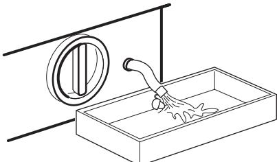
5. Когда вода перестанет литься, отвинтите крышку фильтра (A) и извлеките его. Всегда держите под рукой тряпку, чтобы вытереть воду, которая может пролиться при снятии фильтра.
