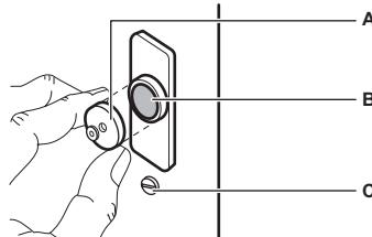
Если требуется перевесить дверцу, чтобы она открывалась слева направо, перенесите на другую сторону накладки Е, магнит Д и накладку С. Установите ответную часть магнита Д и петли А, как описано выше (Рис. 7).
